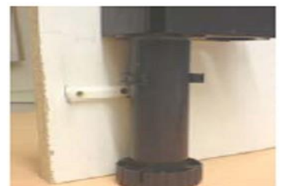
Avstand festeplate til sokkelende minimum 12mm
